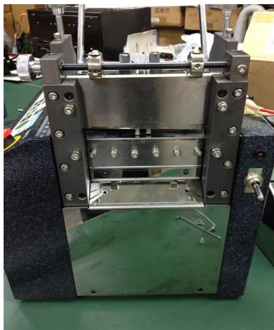
2) 写真赤丸の6本のネジを取り外し、下刃を取り外します。
