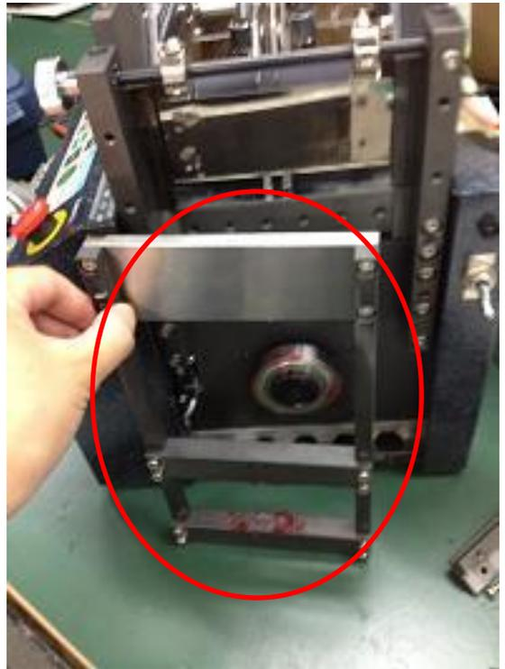
5) 写真赤丸の4本のネジを取り外し、上刃を取り外します。
